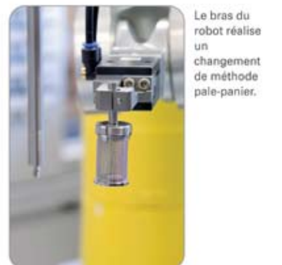
Le bras du robot réalise un changement de méthode palette-panier.
